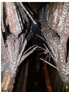
Vorher (links): Bürstmaschine nach vier Monaten ohne Reinigung.
