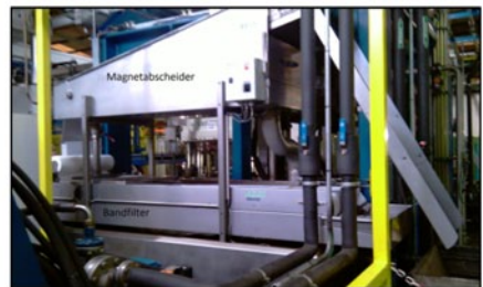
Abb. 17: Schmutzfilter + AGXX-Module: (a) Druckfilter/Filterkerzen, (b) und (c) AGXX-Module SKT + Magnet- und Bandfilter
