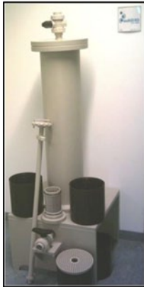
Abb. 13: Bypass-Lösung in Form eines druckbelastbaren Reaktors
