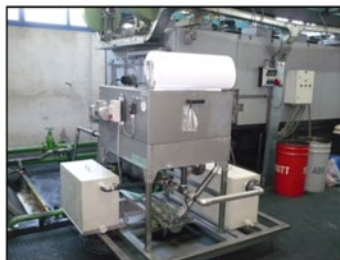
Abb. 17: Schmutzfilter + AGXX-Module: (a) Druckfilter/Filterkerzen, (b) und (c) AGXX-Module SKT + Magnet- und Bandfilter
