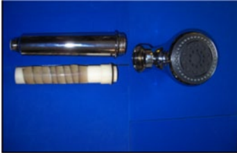
Abb. 18: Kombination von AGXX + Ultra-Filtrationsmodul für Handbrausen
