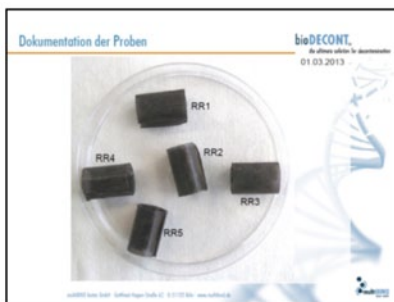
Abb. 23: (a) AGXX-Raschig-Ringe aus dem AGXX-Modul nach einer Reinigung, (b) Test der AGXX-Raschig-Ringe auf einem Nährmedium nach Inkubation zeigt eine noch vollständig erhaltene antimikrobielle Aktivität
