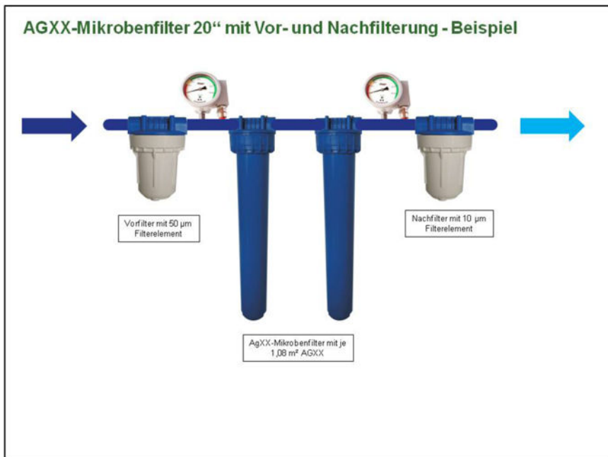
Abb. 19: AGXX-Mikrobenfilter mit Vor- und Nachfilterung
