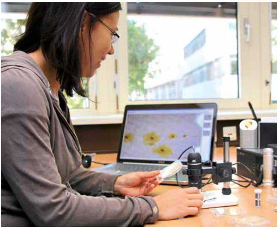
Fleißarbeit: Die Kolonien auf den Nährböden werden unterm Mikroskop aus gezählt. Das erlaubt Rückschlüsse auf die Gesundheitsgefährdung.
